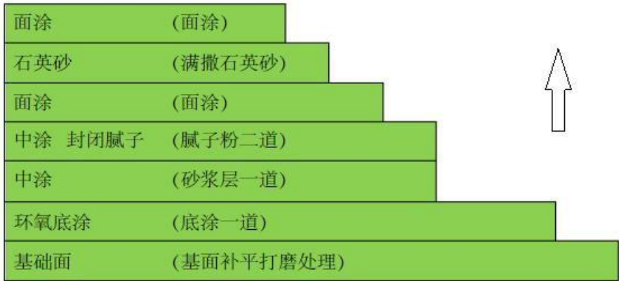
图 6.2-5 5.0mm 环氧石英砂浆工程施工示意图
