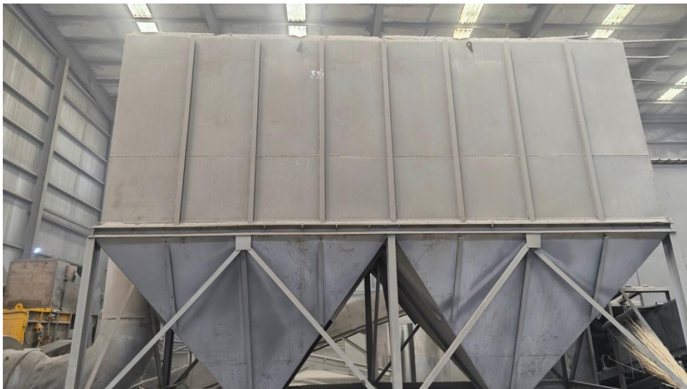
现有工程破碎筛分除尘器
